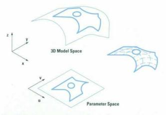
Fig. 4. Trimming in parameter space (p-space).
